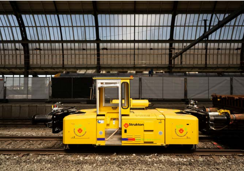
De speciaal voor dit project aangeschafte trekkracht E-Maxi XL is een veilig hulpmiddel bij het rangeren van de wagons. (Beeld: ProRail/Shane van Hattum)
